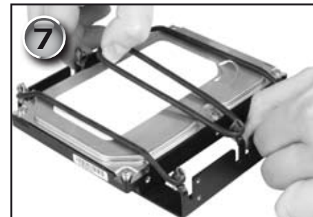
7. Ziehen Sie den äußeren Abschnitt eines Gummiringes auf einer Seite des Rahmens nach oben und schieben Sie die Festplatte vorsichtig darunter (die mittels Kabelbinder verbundenen Teile der Gummiringe kommen unter die Festplatte) (Abb. 5). 9. Befestigen Sie den letzten Gummiring am mittleren Haken des Rahmens (Abb. 7).
