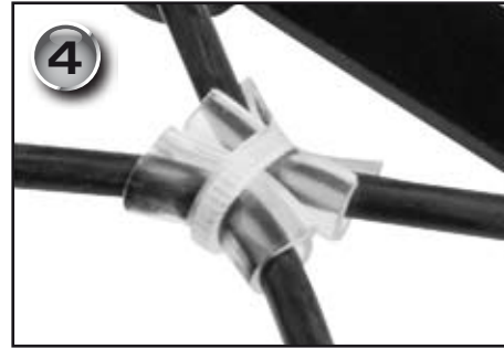
4. Zwei Silikonhülsen weisen einen Längsschnitt auf. Stülpen Sie diese Hülsen über die beiden inneren Abschnitte der Gummiringe (Abb. 4).
