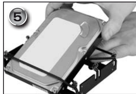
5. Binden Sie mit Hilfe des beiliegenden Kabelbinders die inneren Abschnitte der Gummiringe zusammen und achten Sie darauf, dass der Kabelbinder über die Silikonhülsen läuft (Abb. 4). Schneiden Sie das überstehende Ende des Kabelbinders mit einer Schere ab.
