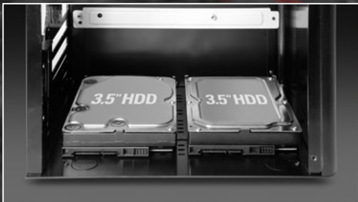
機殼底部 硬碟/SSD 不同配置安裝方式
