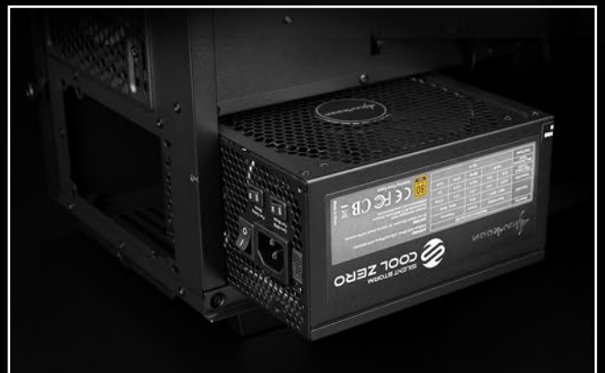
การติดตั้ง Power Supply ให้พัดลมอยู่ด้านบน
