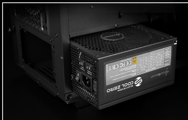
Einbau mit gedrehtem Netzteil
