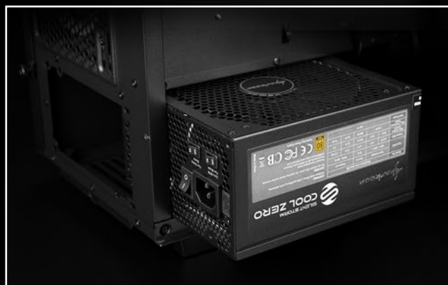
Вентилятор источника питания установлен нижней стороной вверх
