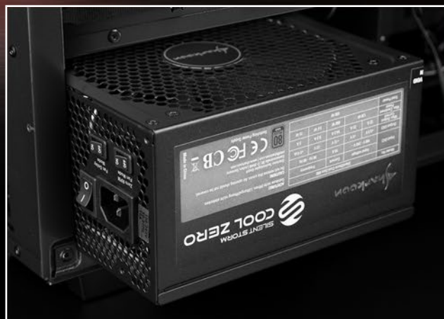
Ventola dell'alimentatore installata in alto
