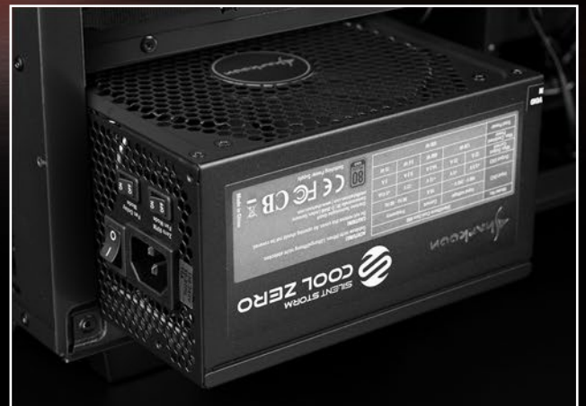
電源のファンを上向きに設置
