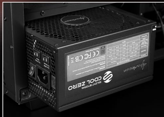
Fan van voeding naar boven geïnstalleerd
