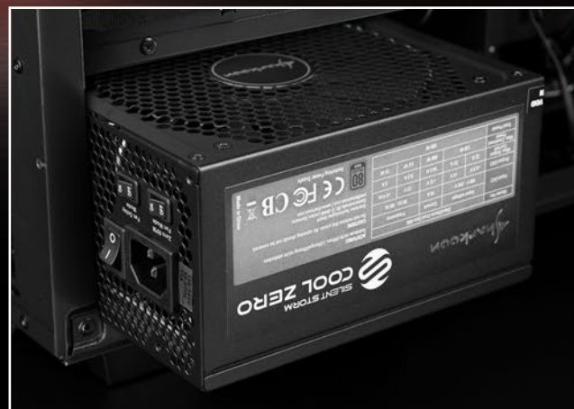
Instalação com a fonte instalada para cima
