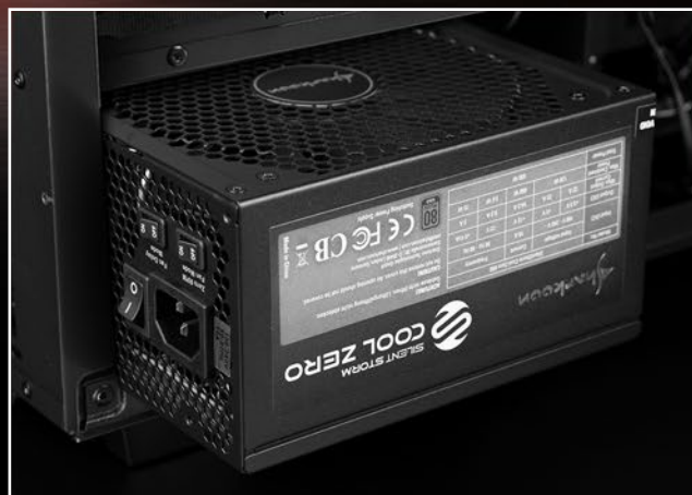
Вентилятор источника питания установлен нижней стороной вверх
