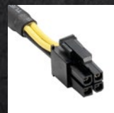
1x 4-контактный разъем питания процессора
